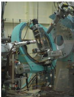
引張試験機を載せてStress-Strainを測定
