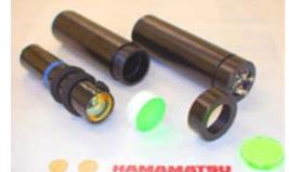
APLFシンチレータを用いた中性子計測器
