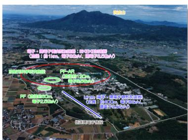
高エネルギー加速器研究機構(KEK)には、PF (2.5GeV) およびと PF-AR (6.5 GeV) の2つの放射光リングがあり、45を超える実験ステーションは基本的に民間企業ユーザーにも開放されている。
