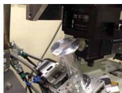
X線CT実験の試料配置
